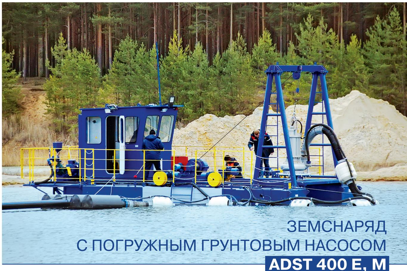
Несамостоятельный землесосный снаряд средней производительности предназначен для дноуглубительных работ, очистки водоемов, добычи нерудных материалов со дна акватории, намыва территории.
